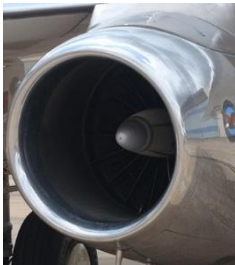
1970 : JT8D Fan diameter : 49,2 '' Bypass ratio : 1,7
